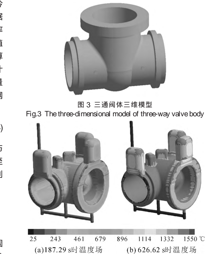
图 4 铸钢件凝固过程温度场分布
